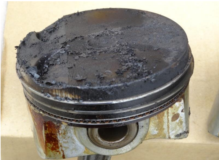
↑ 7年5万キロ走行した軽自動車のピストン ↑ 硬質なエンジンオイル由来のカーボンが堆積していました ※当社で5,000kmごとにオイル交換実施(オイル消費現象なし)
